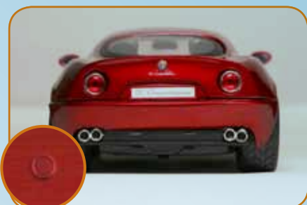
Eingebauter Sensor, lackiert in Wagenfarbe
